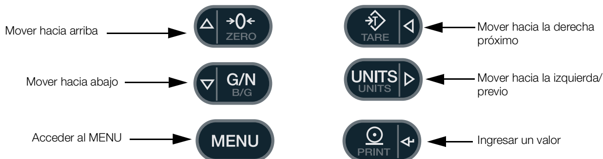
Figura 1-5. Funciones de las teclas del panel frontal en el Modo de Configuración
