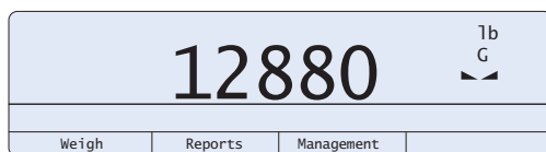
Figure 1-3. Pantalla 720i mostrando las teclas programables del Modo de Avance
