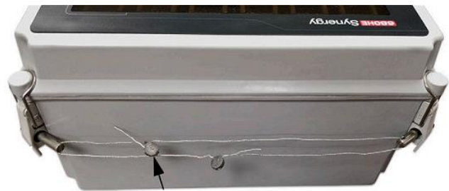
Typical sealing for model 680HE / Scellage typique pour le modèle 680HE
