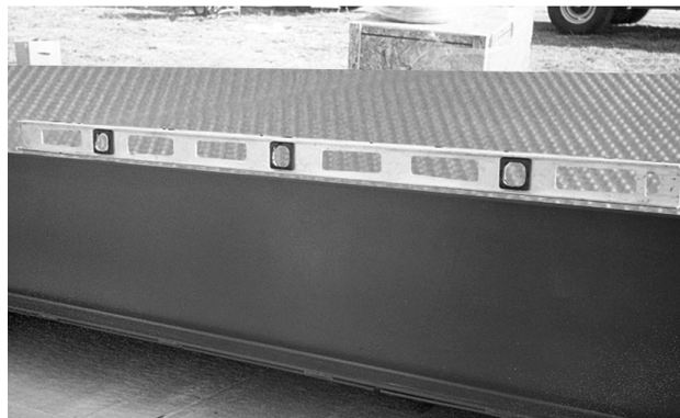
Figura 2-8. Verifique la Nivelación del Puente de Pesaje
