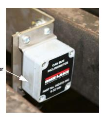
Figure 3-4. Install Inclinometer
