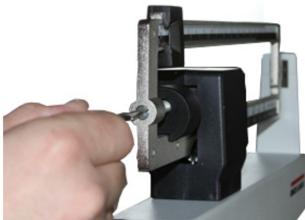
Figura 4-2. Ubicación del Tornillo para Ajuste del Cero
