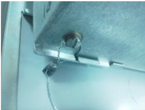
Typical sealing on the 1280-3y, 1280-4y, 1280-5y and 1280-6y / Scellage typique pour le modèles 1280-3y, 1280-4y, 1280-5y et 1280-6y
