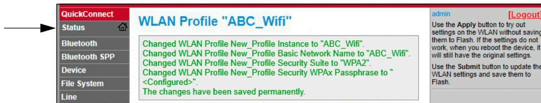
12. Die Seite **Status** zeigt die Netzwerkverbindungen auf dem Gerät unter **Network Settings (Netzwerkeinstellungen)** an.
