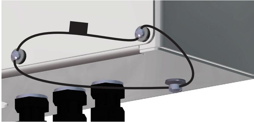
Abbildung 2-30. Versiegeln eines Geräts mit Universal-Montagehalterung
