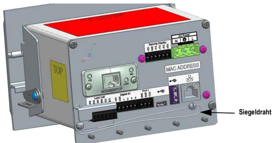
Abbildung 2-29. Siegeldraht einsetzen
