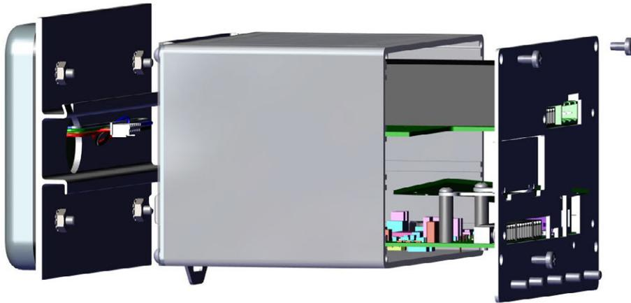
Abbildung 2-9. Controller-Rückplatte abbauen
