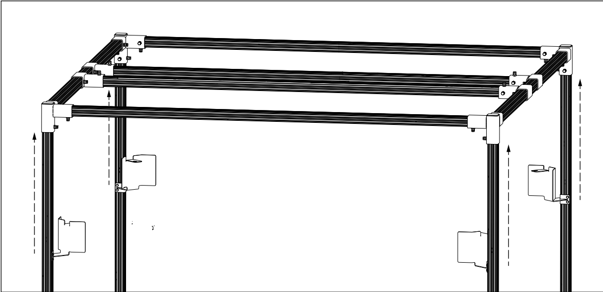
Abbildung 3-14. Montage der Schutzvorrichtungen für die Remote-IFM-Sensoren
