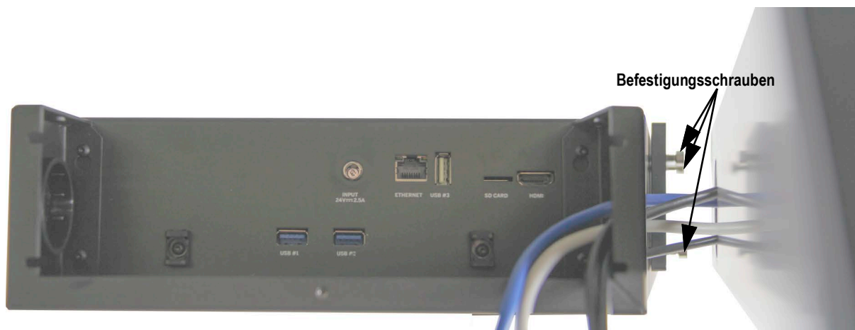
Abbildung 3-13. Kabel durch den Kopf führen
