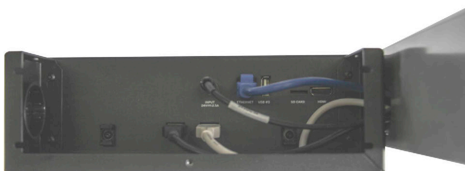
Abbildung 3-17. Verbindungen am Scankopf
