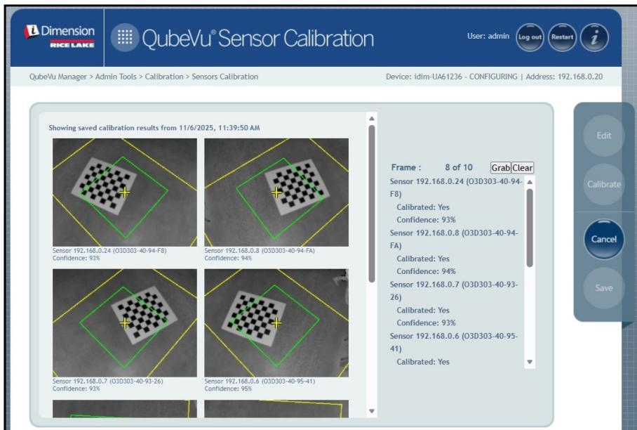
Abbildung 6-22. Kalibrierungsobjekt unter Volumenmesssystem
