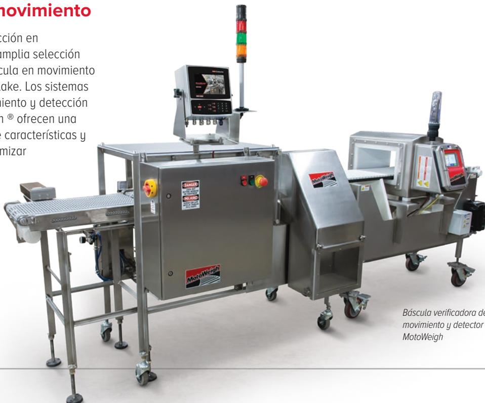
Báscula verificadora de peso en movimiento y detector de metal MotoWeigh
