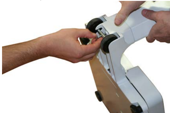
Figura 2-4. Fijar el conjunto de ruedas
