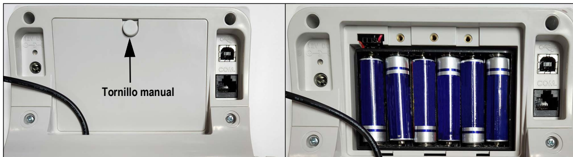
Figura 2-4. Cámara de pilas
