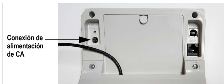
Figura 2-5. Sitio de conexión eléctrica
