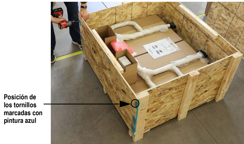
Figura 2-3. Extracción de los tornillos del panel lateral
