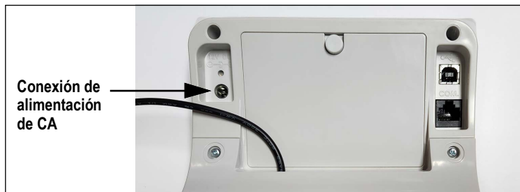
Figura 2-15. Sitio de conexión eléctrica
