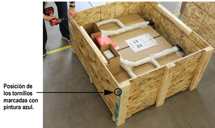
Figura 2-3. Extracción de los tornillos del panel lateral
