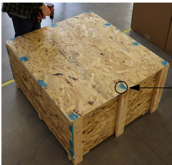
Figura 2-1. Extracción de los tornillos de la cubierta de la caja
