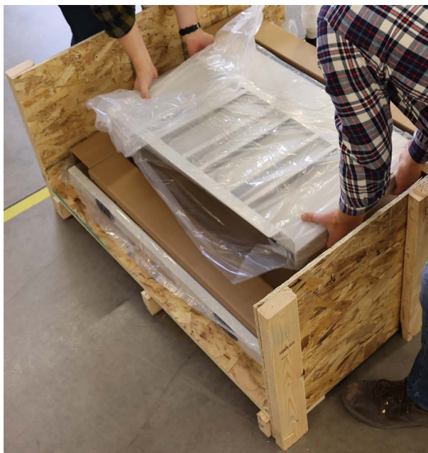
Figura 2-6. Desembalaje de la rampa de báscula
