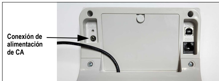
Figura 2-15. Sitio de conexión eléctrica
