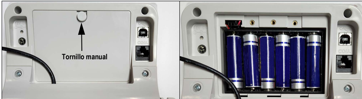
Figura 2-14. Cámara de pilas
