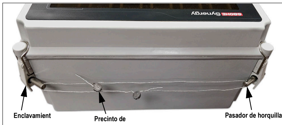
Figura 2-9. Precintado del indicador, prevención del acceso
