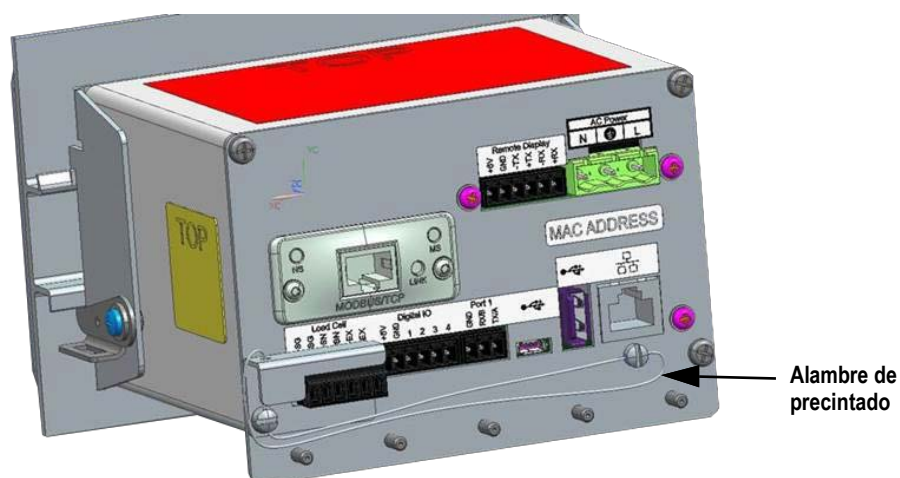
Figura 2-29. Instale el alambre de precintado
