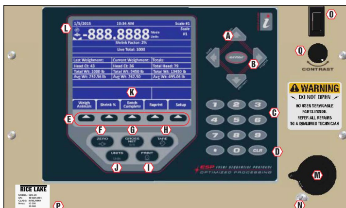
Figura 1-6. Panel frontal del visor 920i
