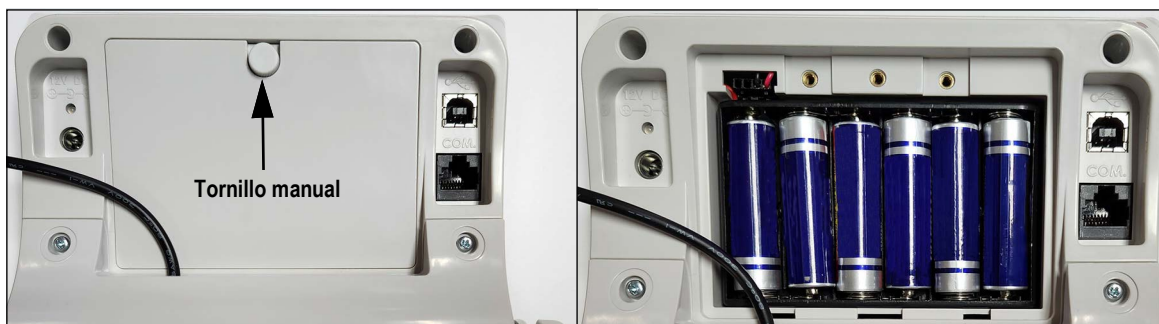
Figura 2-4. Cámara de pilas
