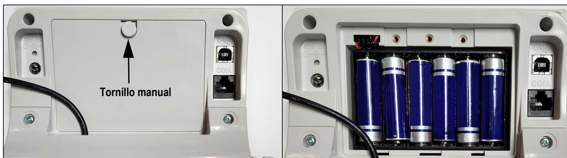
Figura 2-4. Cámara de pilas
