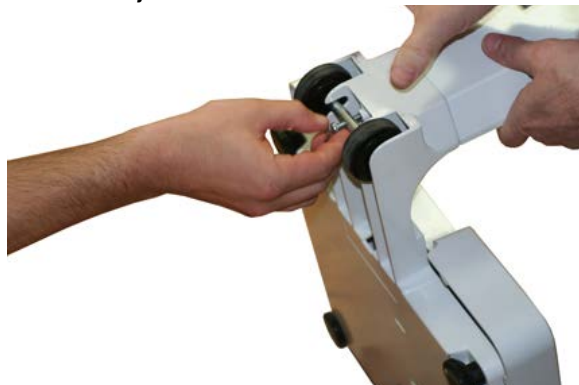
Figura 2-4. Fijar el conjunto de ruedas
