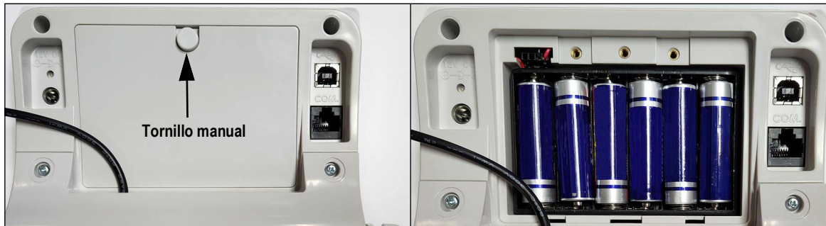
Figura 2-7. Cámara de pilas
