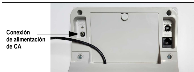
Figura 2-8. Sitio de conexión eléctrica
