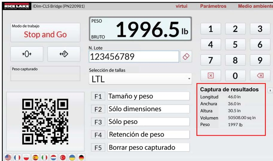
Figura 6-3. iDim CLS Bridge con resultados de captura (mediante dimensionador)
