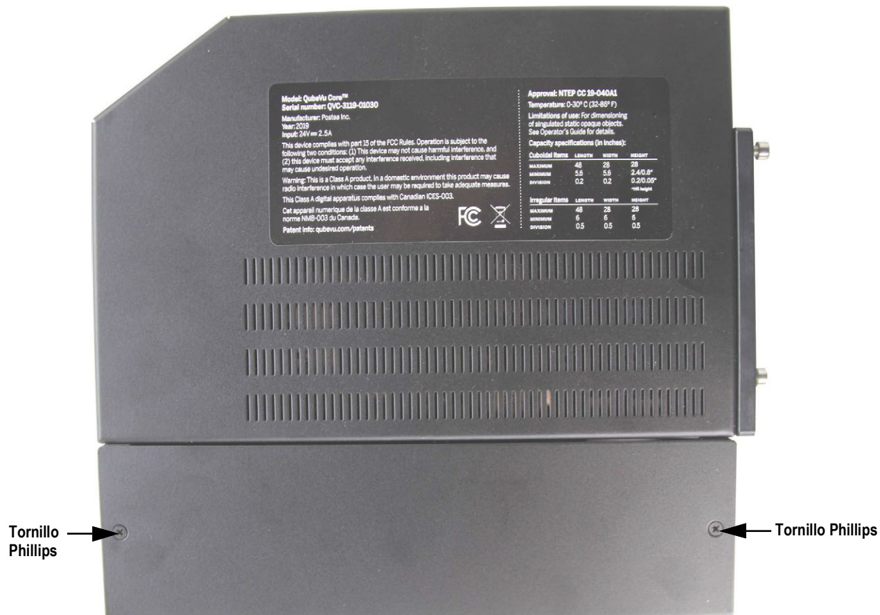
Figura 3-18. Fijación de la cubierta posterior del cabezal de escaneo
