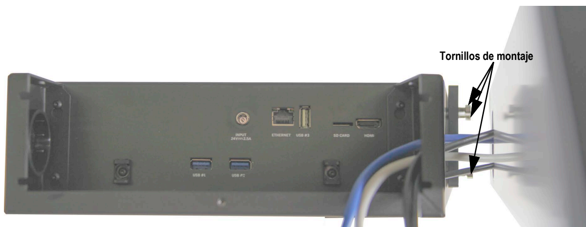
Figura 3-13. Pase los cables a través del cabezal
