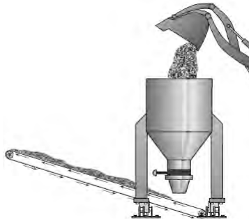
Figura 12-5. Tolva de pesaje alimentada por cargador
