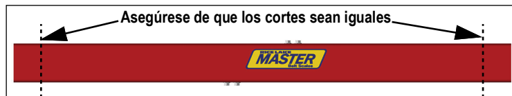
Figura 2-7. Redimensionar el bastidor de pesaje – 311M solo
