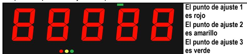
Figura 4-1. LED de puntos de ajuste
