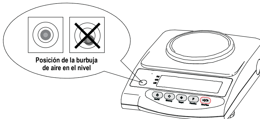
Figura 2-3. Nivelar la báscula
