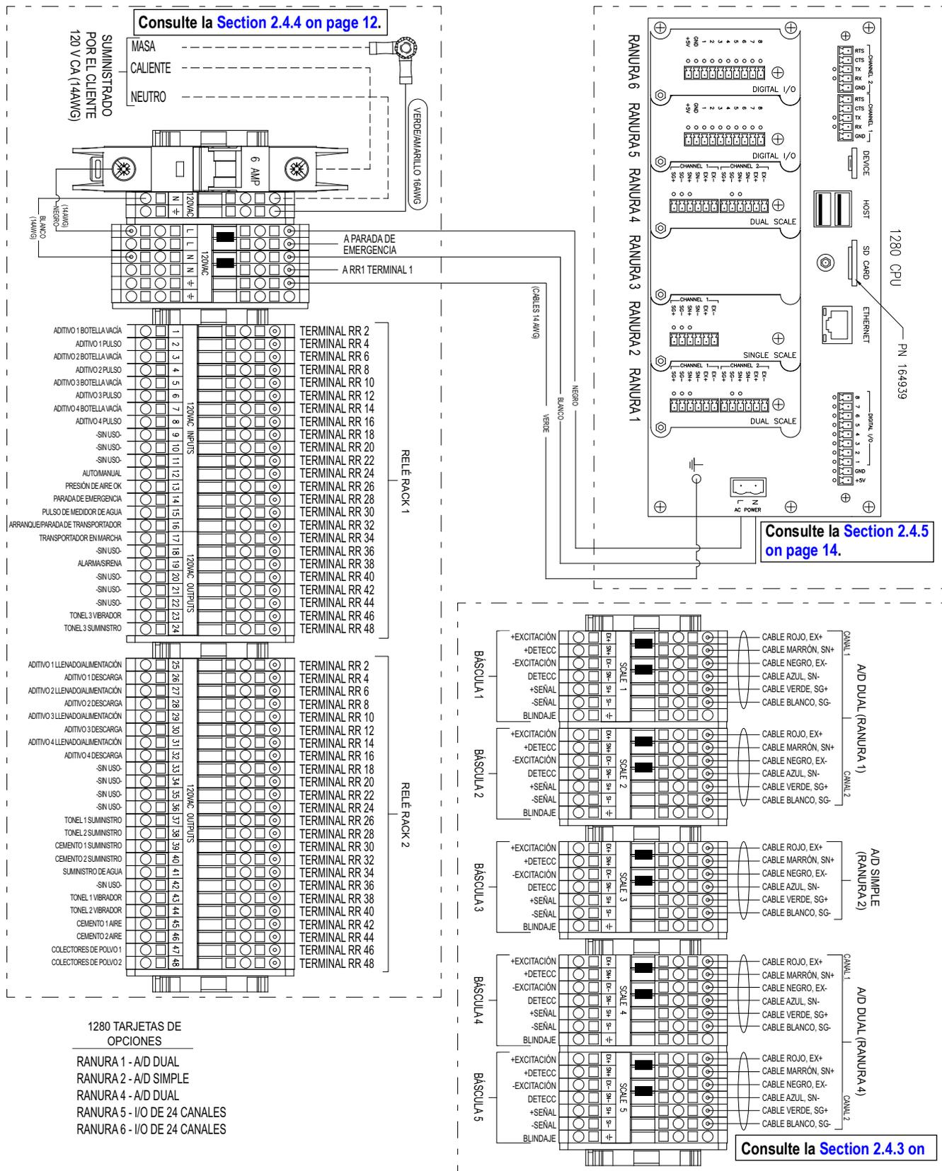
Figure 2-1. Diagrama de cableado del dosificador de concreto decumulativo FlexWeigh 1280
