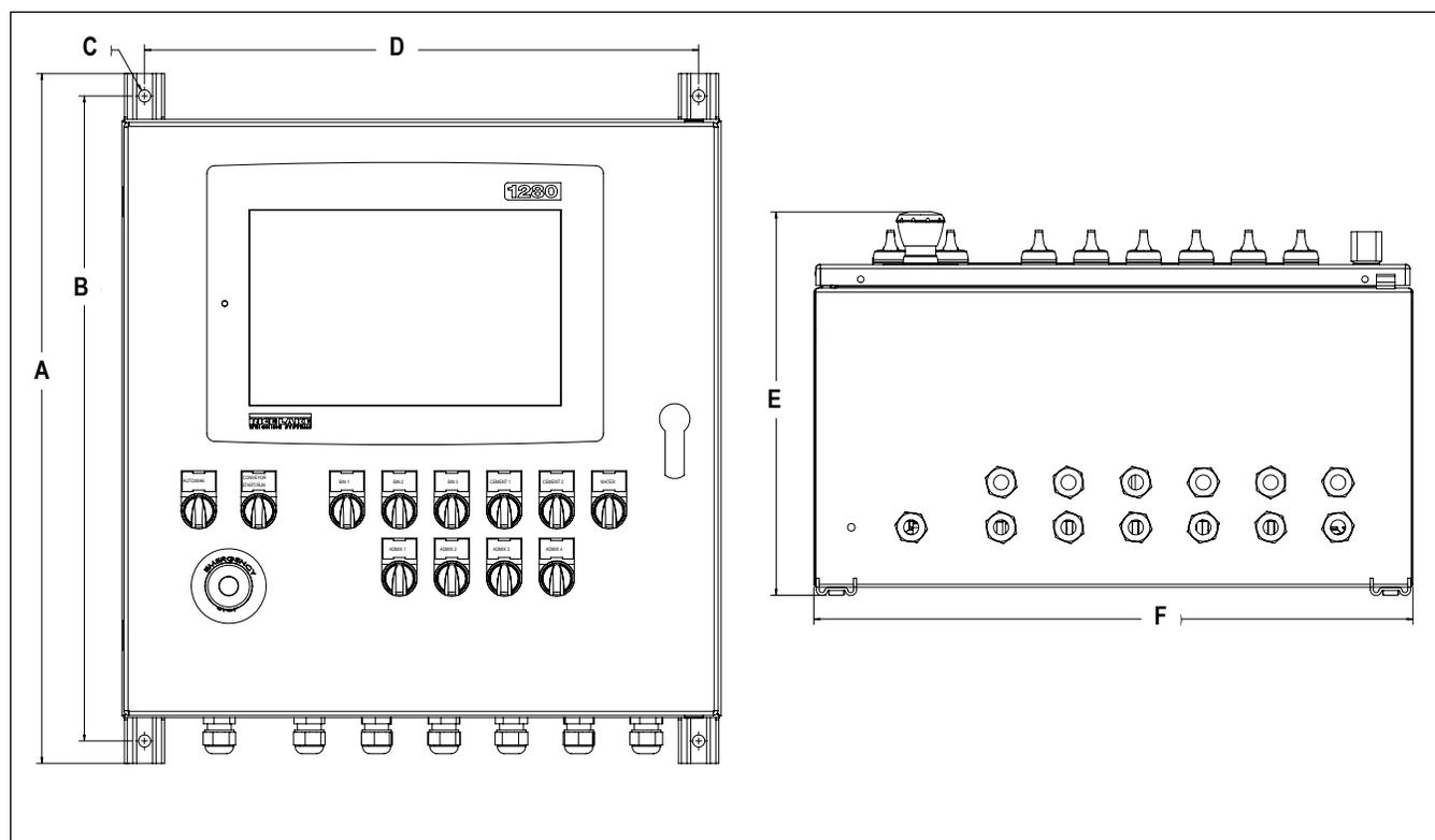
Figure 1-1. Dimensiones del dosificador de concreto decumulativo FlexWeigh 1280
