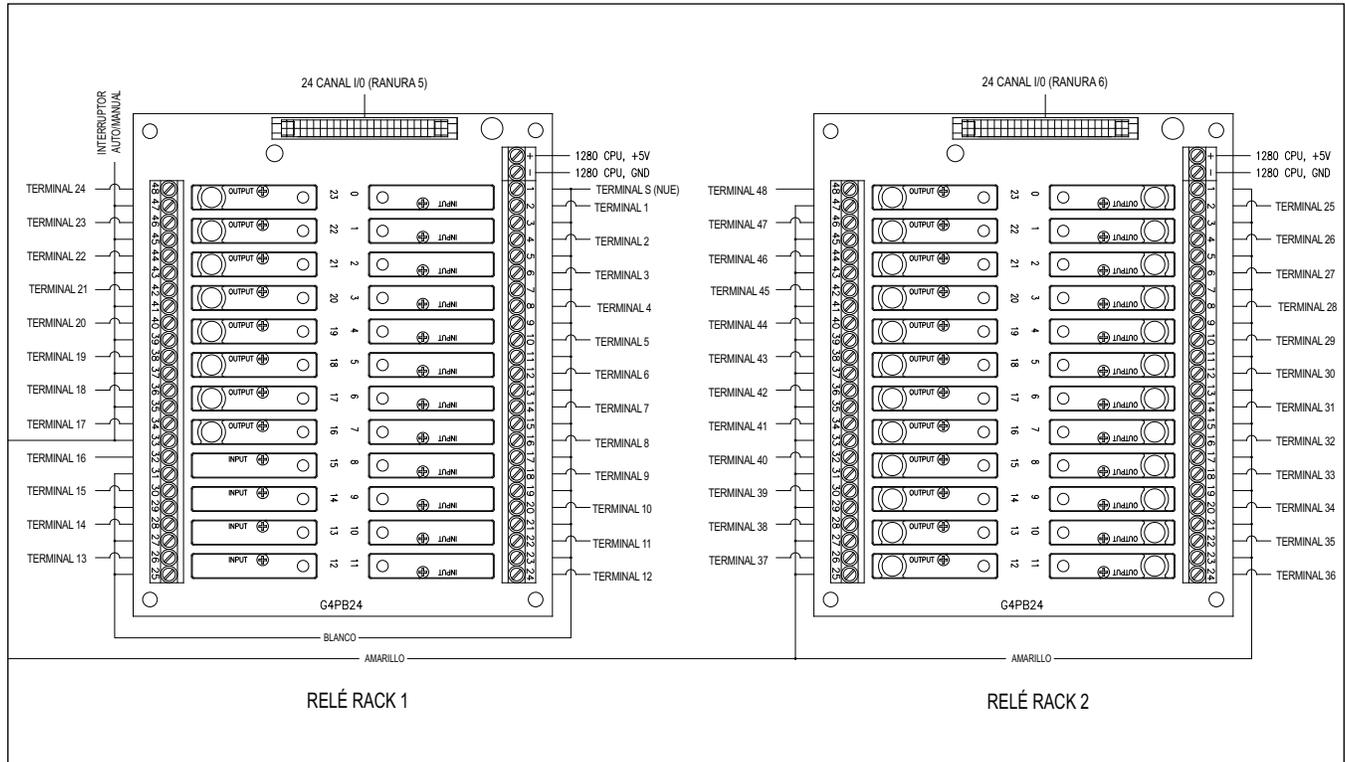
Figure 2-5. Diagrama de cableado de relés del dosificador de concreto decumulativo FlexWeigh 1280
