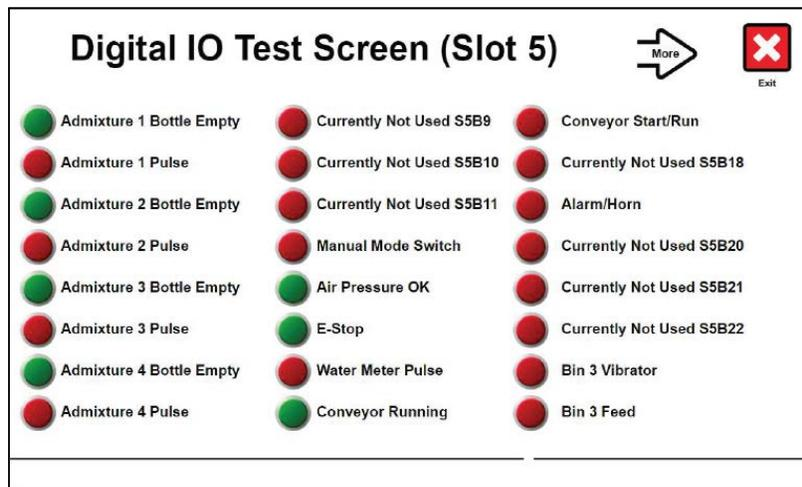
Figure 3-2. Pantalla de prueba de I/O digitales
