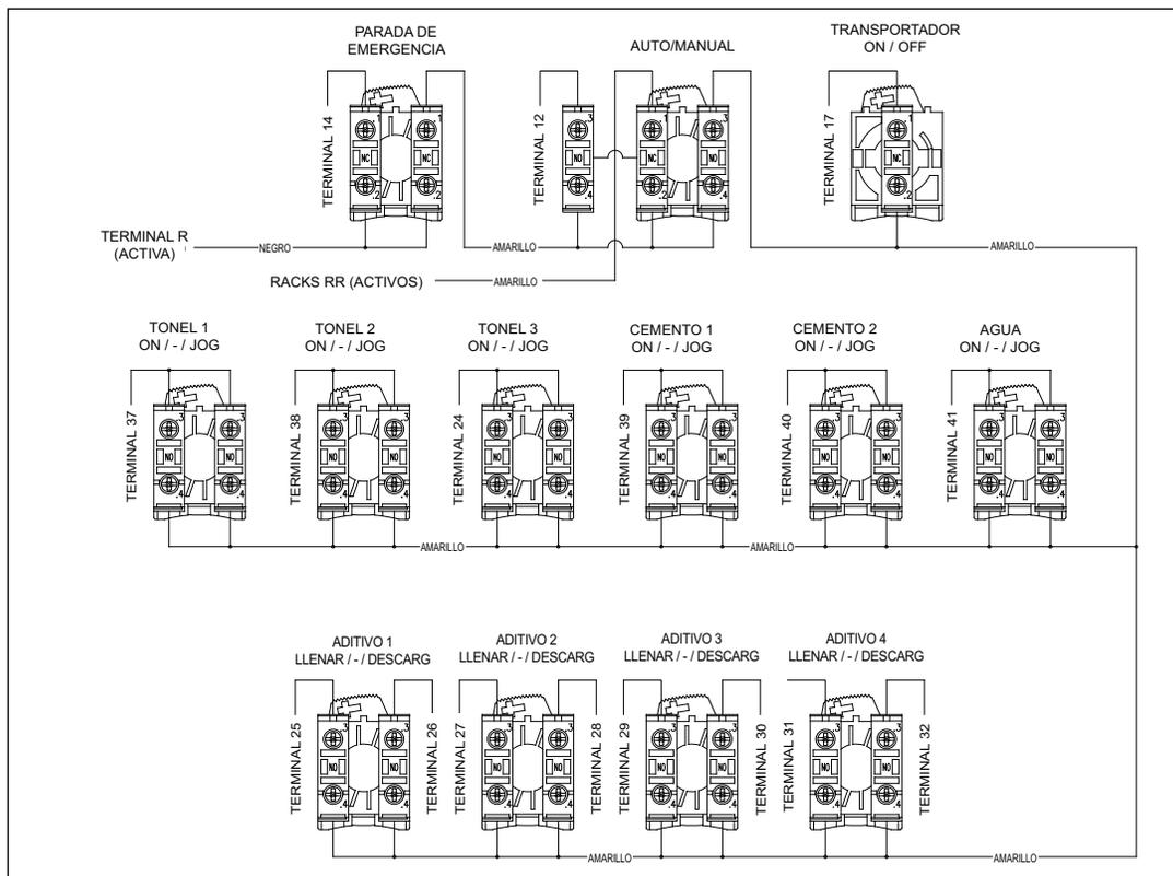
Figure 2-6. Diagrama de cableado de terminales del dosificador de concreto decumulativo FlexWeigh 1280
