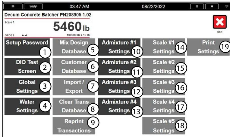
Figure 3-1. 1280 Menú Setup (Puesta en servicio) del dosificador de concreto decumulativo FlexWeigh
