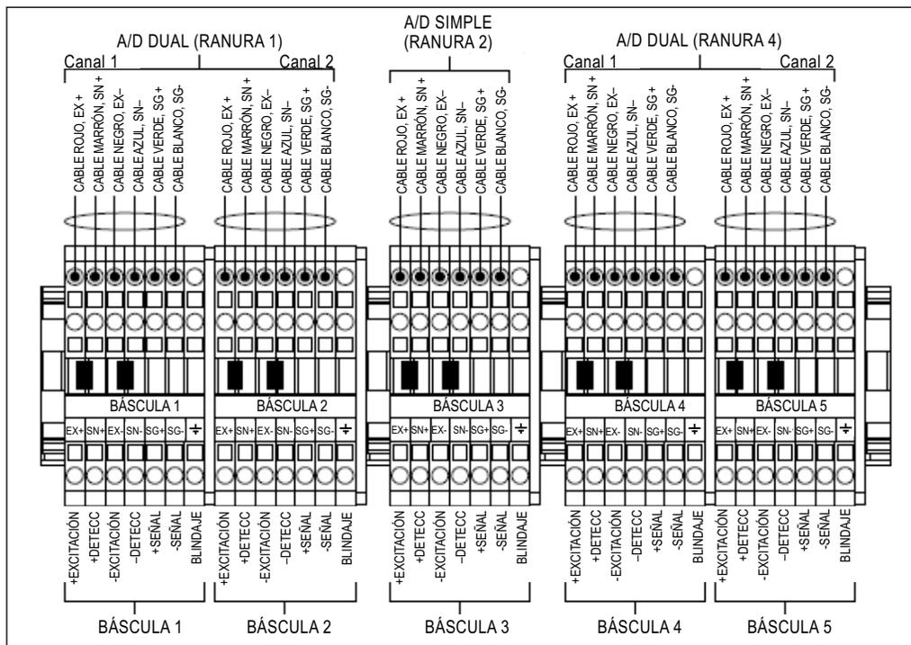
Figure 2-2. Diagrama de cableado de báscula
