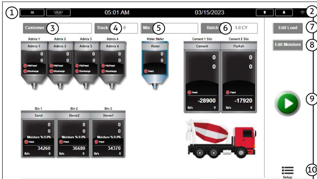
Figure 4-1. Interfaz principal del dosificador de concreto
