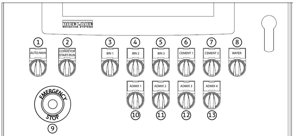
Figure 1-2. Teclas del panel frontal
