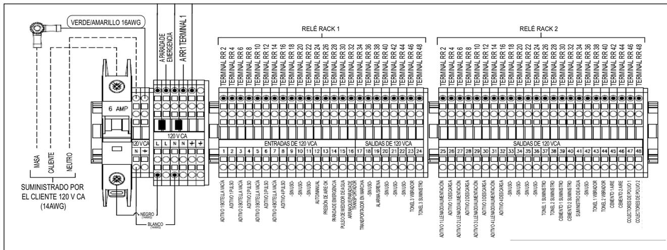
Figure 2-3. Diagrama de cableado de I/O digitales
