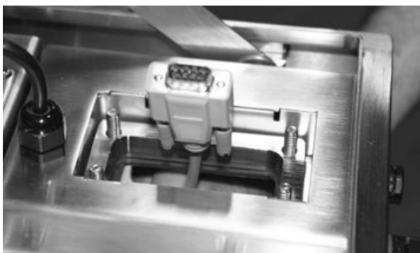
Figura 2-7. El cable de comunicaciones sale por el fondo del orificio
