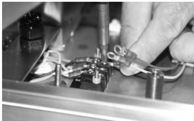
Figura 5-11. Haga coincidir los colores de los cables del mazo de cables y de la regleta de terminales
