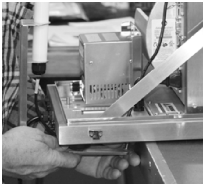
Figura 5-25. Instalación de los pernos y el cable del kit de antena por la base de la impresora
