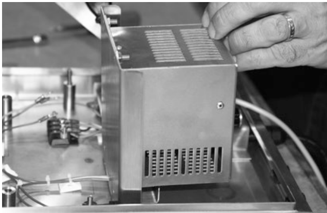
Figura 5-10. Asegure el calentador a la parte inferior de la carcasa
