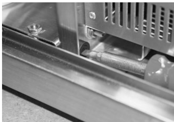
Empuje y gire para extraer el fusible
