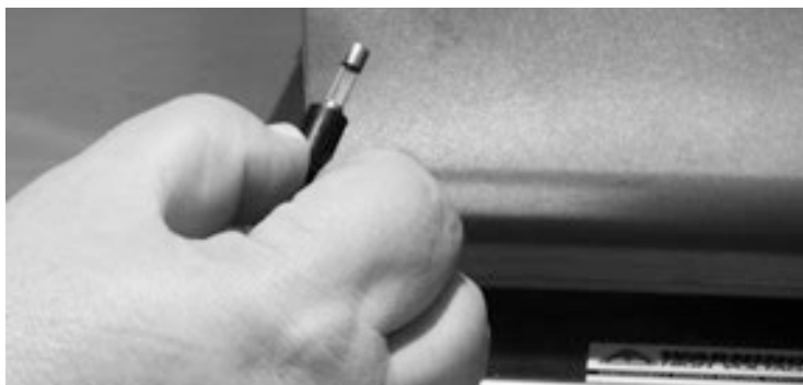
Figura 5-19. Retire el fusible actual del receptáculo y sustitúyalo por uno nuevo
