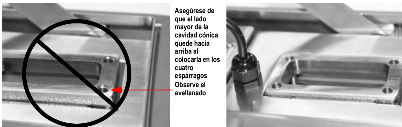
Figura 2-6. Orientación incorrecta y correcta de la placa principal
