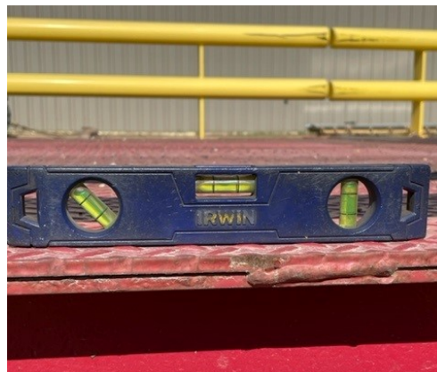
Figura 3-8. Comprobar el nivel de la báscula puente
