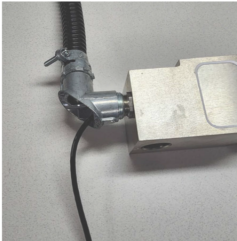
Figura 4-3. Instalación del racor de 90° a la celda de carga
