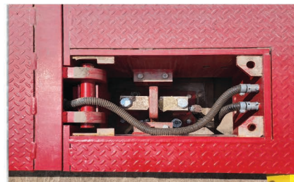
Figura 5-5. Conexión de conductos entre módulos de plataforma
