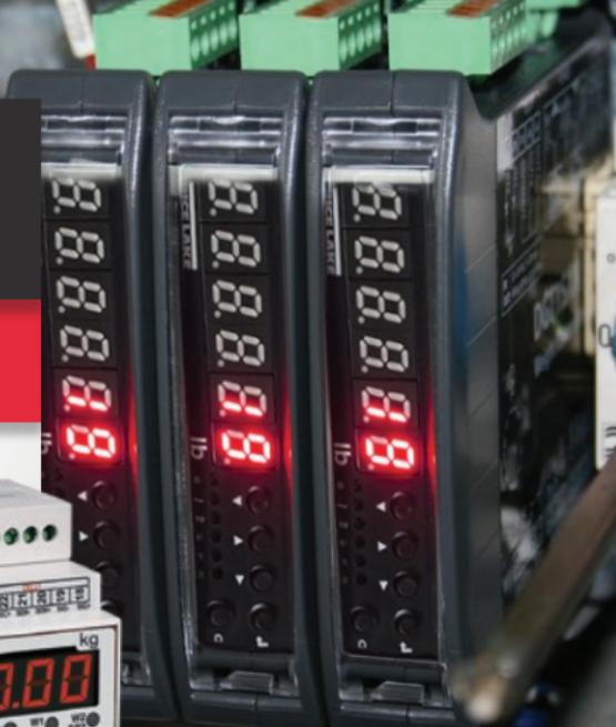
Les transmetteurs de conditionnement de signal (SCT) permettent de contrôler les données de poids pour les automates programmables industriels (PLC) et sont plus compacts que les indicateurs de poids traditionnels. Ces systèmes permettent la lecture et le diagnostic directs de chaque capteur de charge individuel ou de tous les capteurs de charge dans leur ensemble.
