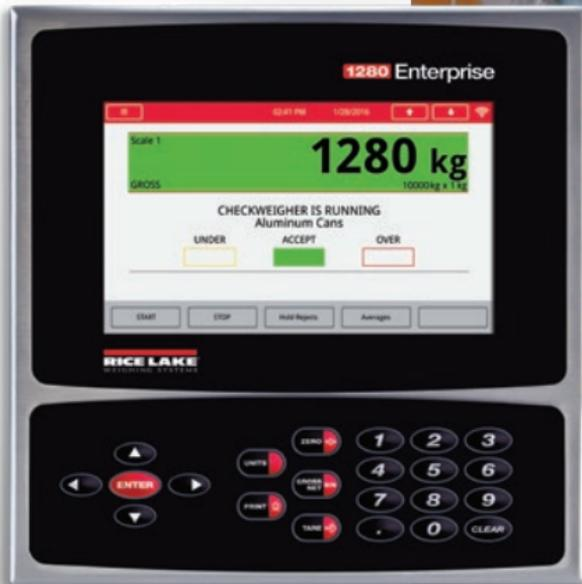
L'indicateur programmable série 1280 Enterprise permet un fonctionnement rapide et se développe facilement pour croître avec votre entreprise. Le système 1280 a plus de 150 fonctions intégrées et des applications personnalisées peuvent être créées avec le logiciel iRite® de Rice Lake. Le traitement multitâche est simple grâce à l'affichage graphique hautement personnalisable du 1280, au processeur Quad Core et à sa capacité à alimenter jusqu'à huit balances.
