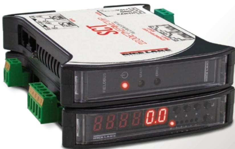
L'émetteur de poids SCT-2200 offre toutes les fonctions de contrôle des données de poids pour PLC sans les exigences d'espace d'un indicateur de poids traditionnel. Le SCT-2200 convertit les signaux du capteur de charge d'une balance en sortie analogique, sortie série ou protocole réseau spécifique.
