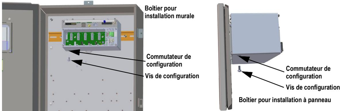
Figure 3-2. Emplacements des commutateurs de configuration (boîtiers pour installation murale/à panneau)
