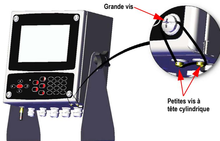
Figure 2-7. Scellement de la porte frontale (support de fixation universel)
