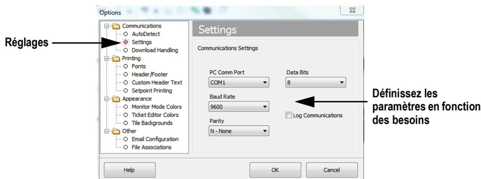
Figure 14-6. Définition des paramètres de communication
