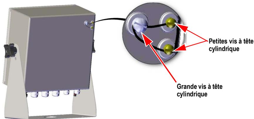
Figure 2-6. Scellement du commutateur de configuration (support de fixation universel)
