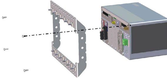
Figure 2-18. Installation de la barre omnibus de mise à la terre
