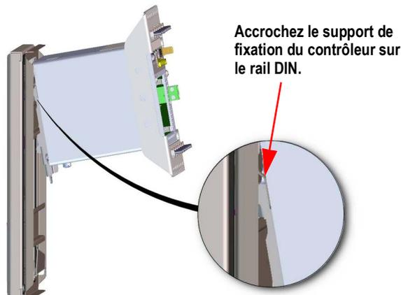
Figure 2-20. Accrochez la plaque de fixation sur le rail DIN
