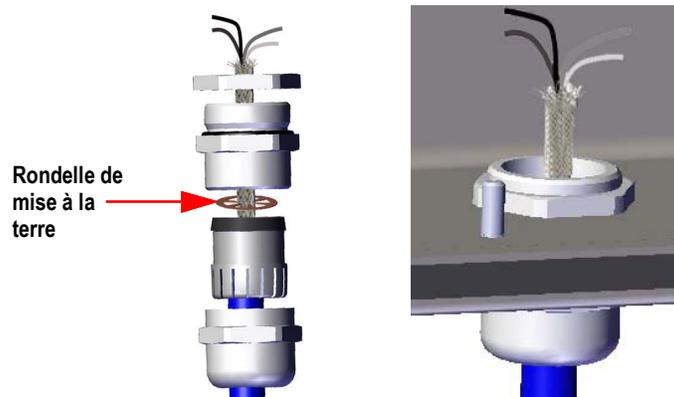
Figure 2-27. Mise à la terre des boîtiers universel et pour installation à panneau
