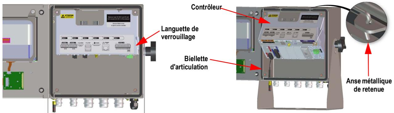
Figure 2-3. Déposez l'ensemble UC - Universel
