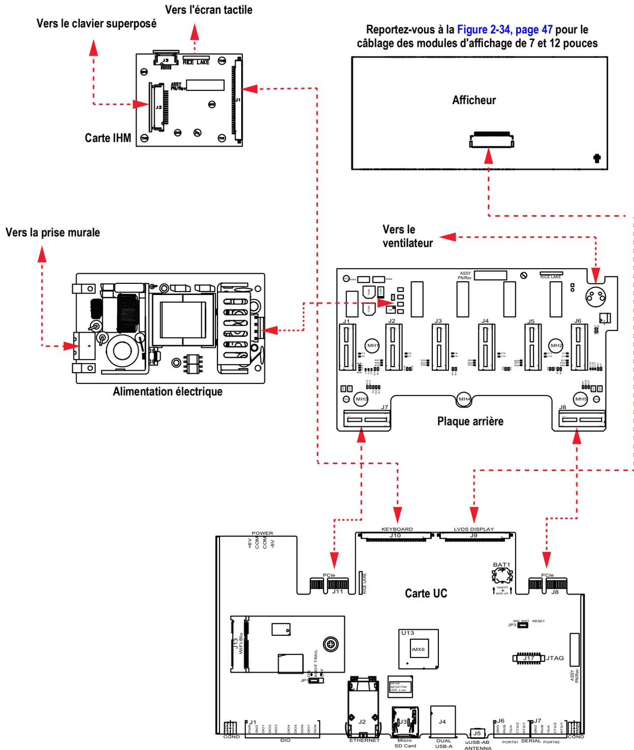
Figure 2-33. Schéma de câblage
