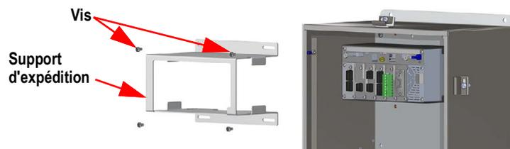
Figure 2-9. Déposez le support d'expédition
