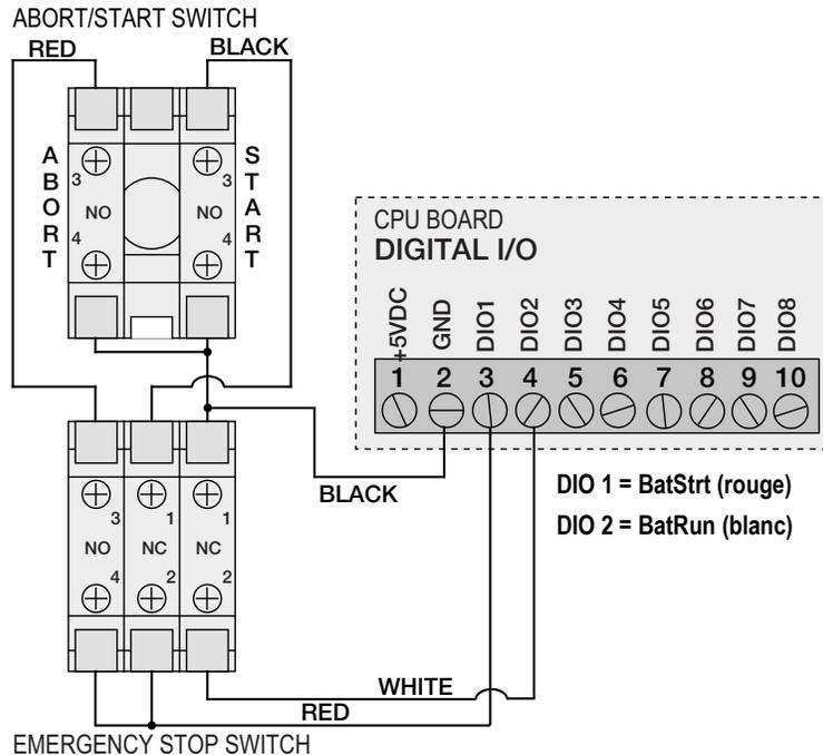
Figure 10-14. Exemple de schéma de câblage de commutateur de mise en lots
