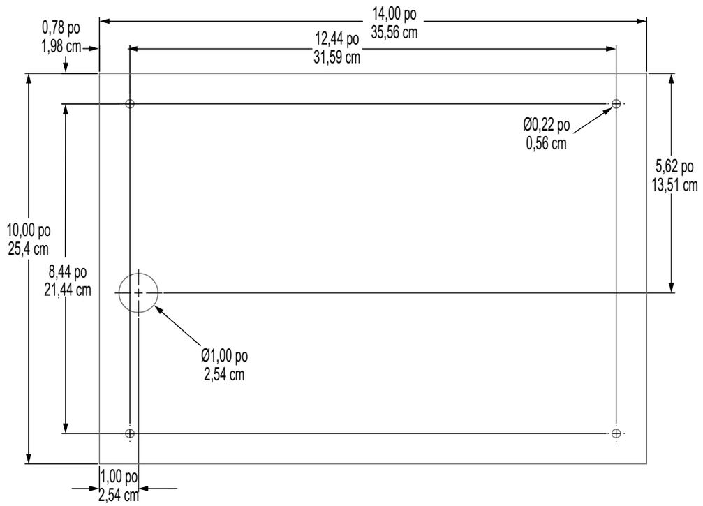
Figure 2-17. Dimensions du support à panneau pour modèle tactile 12 pouces
