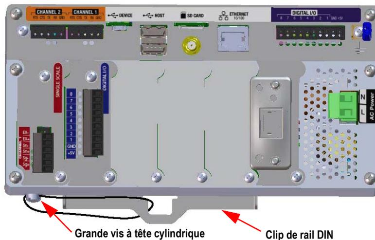
Figure 2-22. Scellement du commutateur de configuration (boîtier pour installation à panneau)
