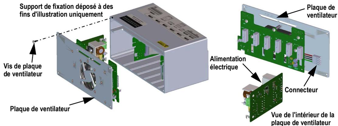
Figure 2-37. Retrait de l'alimentation électrique
