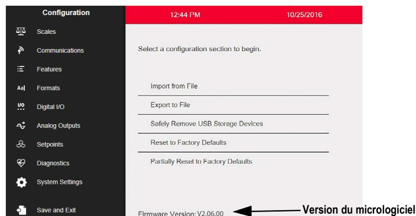
Figure 14-8. Vérification de la version du micrologiciel
