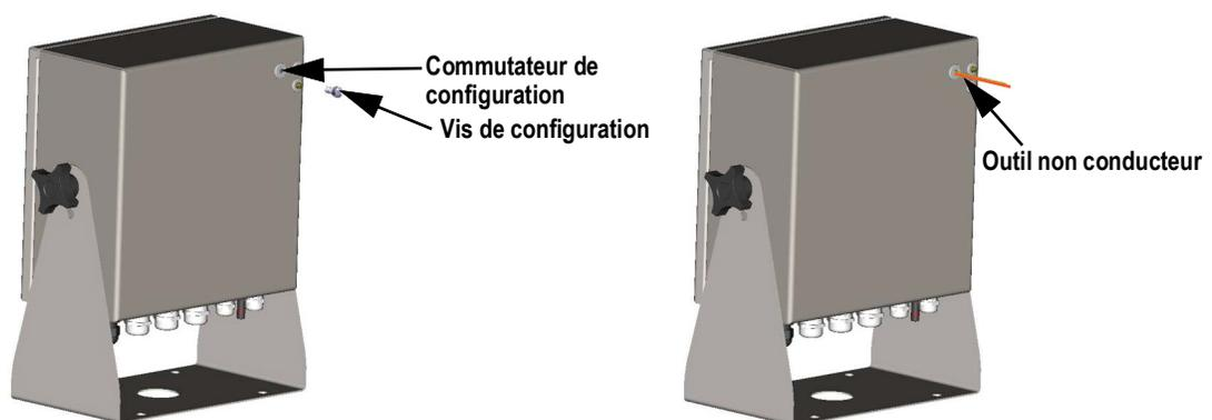
Figure 3-1. Emplacement du commutateur de configuration (boîtier universel)
