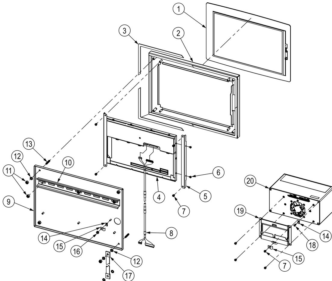
Figure 2-45. Pièces de rechange pour installation à panneau 12 pouces Fonction tactile uniquement
