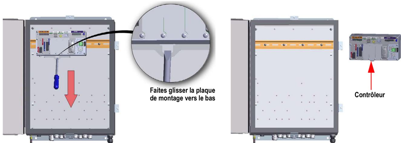
Figure 2-11. Dépose du contrôleur - fixation murale
