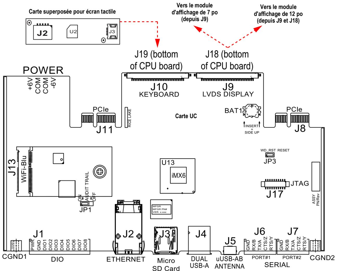
Figure 2-34. Installations à panneau – Écran tactile 7 pouces et 12 pouces uniquement
