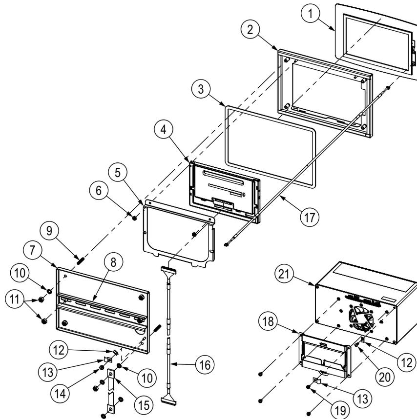
Figure 2-44. Pièces de rechange pour installation à panneau 7 pouces Fonction tactile uniquement
