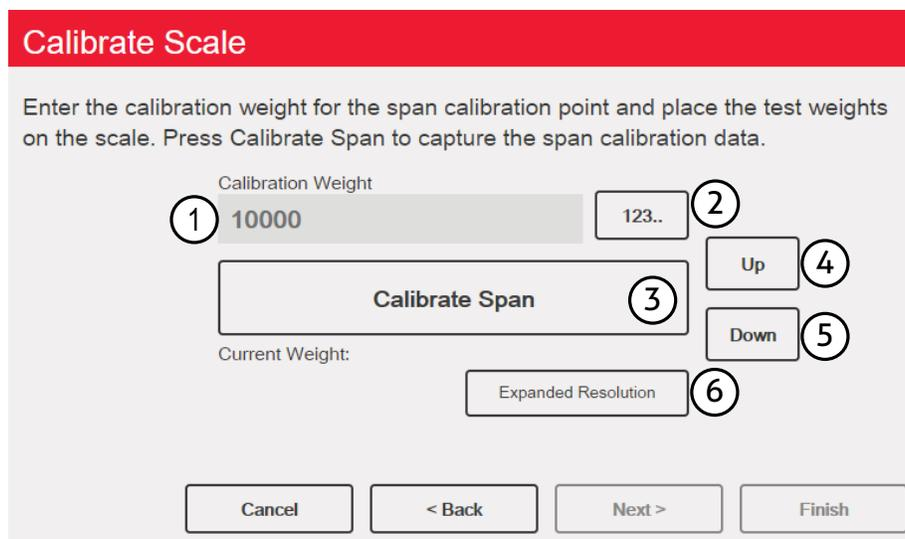
Figure 4-5. Calibrate Span (Étalonner l'intervalle de mesure)
