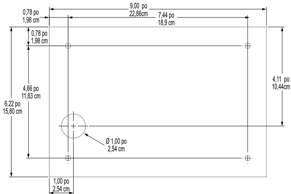
Figure 2-16. Dimensions du support à panneau pour modèle tactile 7 pouces
