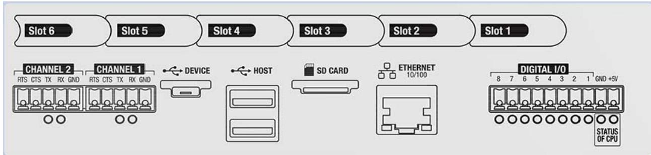
Figure 2-23. Étiquette sur le haut du contrôleur
