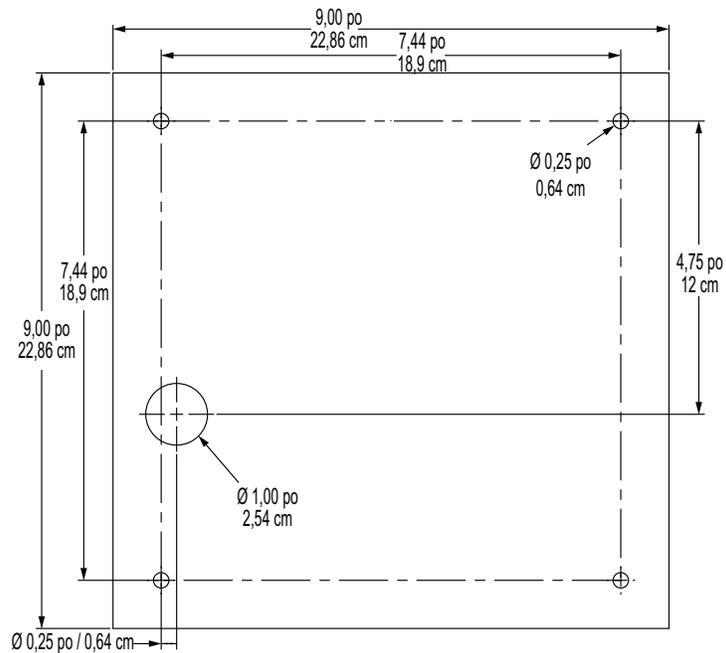
Figure 2-15. Dimensions du support de fixation pour installation à panneau 7 pouces (avec clavier)
