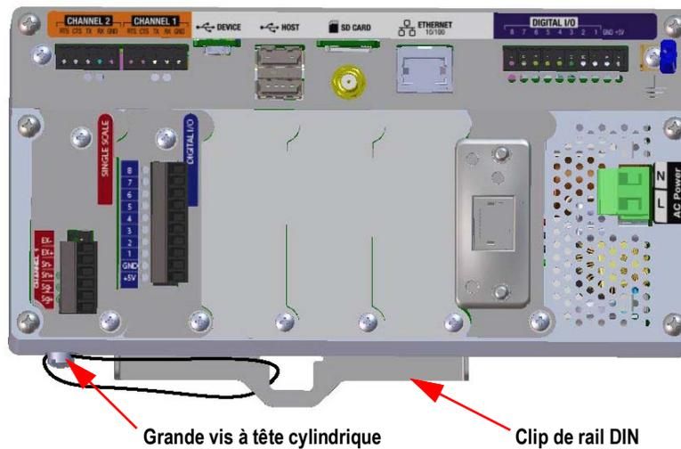
Figure 2-12. Scellement du commutateur de configuration
