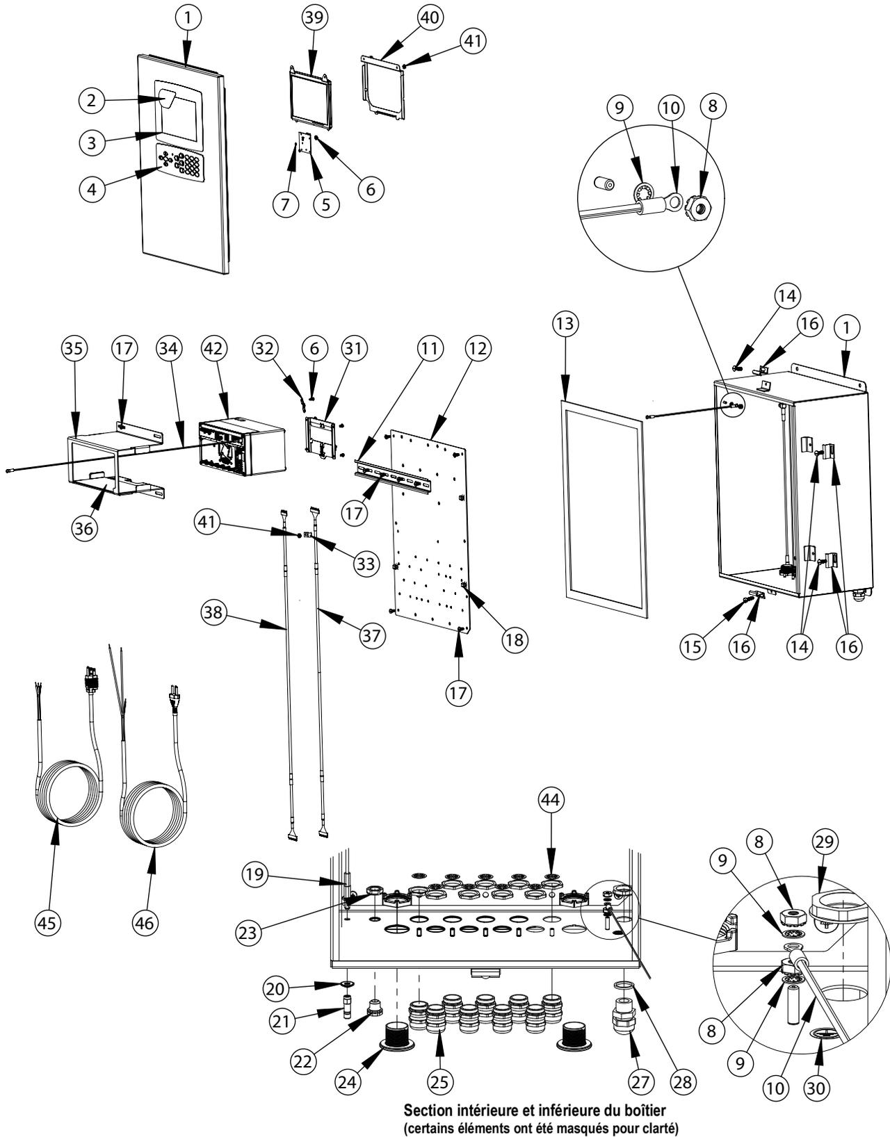
Figure 2-42. Pièces de rechange du modèle pour installation murale
