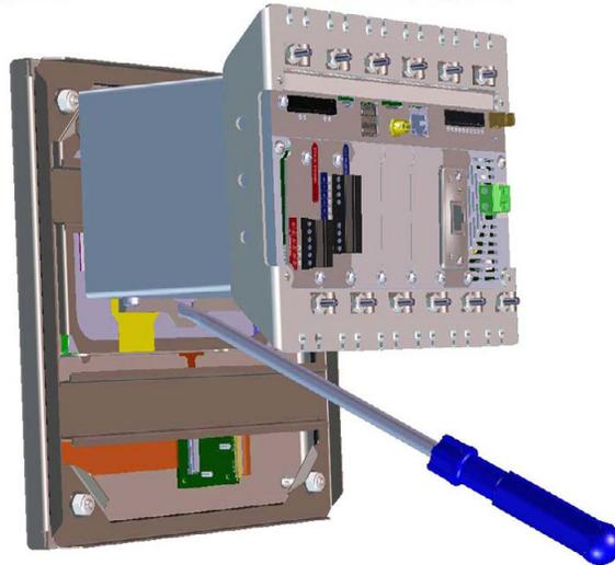
Figure 2-21. Dépose du contrôleur
