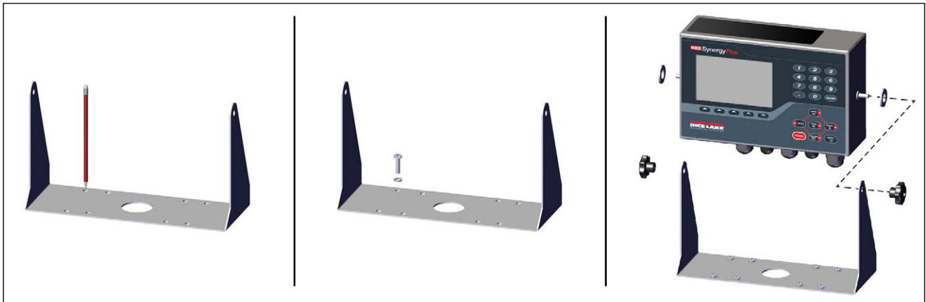
Figure 2-3. Installation de l'indicateur
