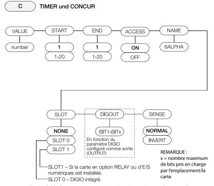
Figure 3-20. Structure du menu de points de consigne - Structure C
