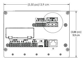
Figure 2-1. Dimensions de l'indicateur 880 à boîtier pour installation à panneau
