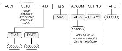
Figure 3-2. Structure du menu de l'indicateur 880
