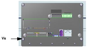
Figure 2-25. Vis de plaque inférieure
