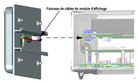
Figure 2-7. Faisceau de câbles du module d'affichage
