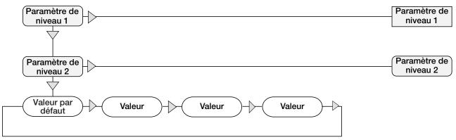
Lorsque vous parcourez les valeurs sous le menu de niveau 1, appuyez sur △ pour revenir au niveau supérieur. Appuyez sur 〈 ou 〉 pour passer au paramètre suivant sur ce niveau.
