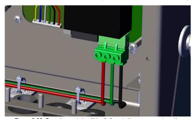
Figure 2-22. Branchement du câble d'alimentation en courant continu
