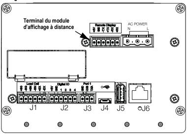
Figure 2-5. Installation du contrôleur à distance
