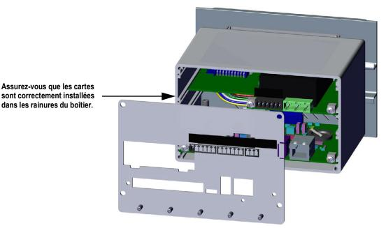
Figure 2-12. Cartes installées dans le boîtier du contrôleur
