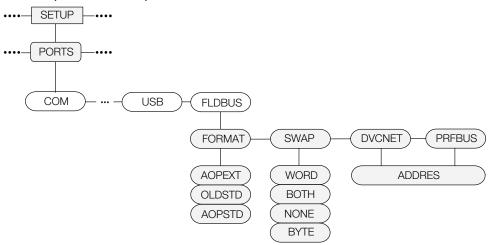
Figure 3-15. Paramètres de menu de bus de terrain
