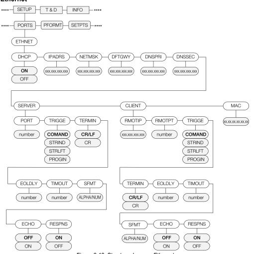
Figure 3-13. Structure du menu Ethernet
