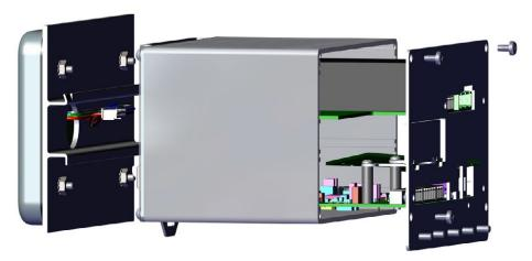
Figure 2-9. Dépose de la plaque arrière du contrôleur
