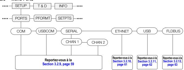
Figure 3-11. Structure du menu Ports
