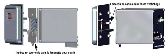
Figure 2-4. Installation du contrôleur
