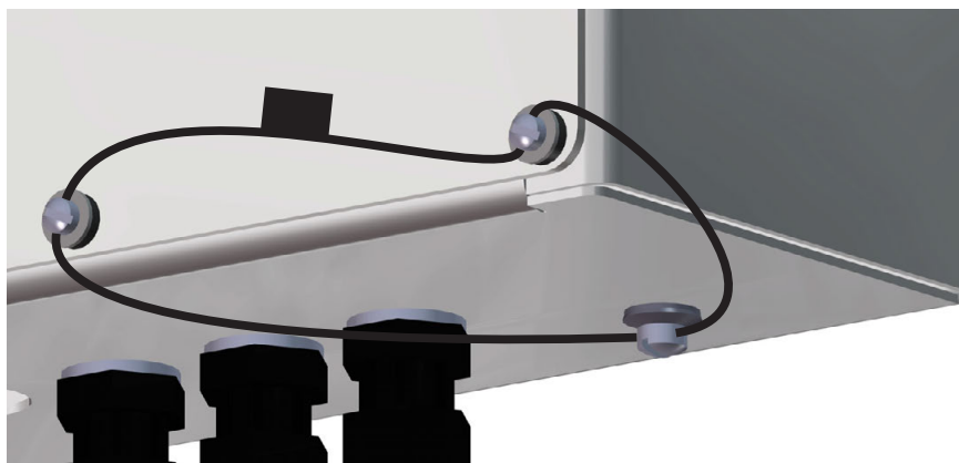
Figure 2-30. Scellement du boîtier universel
