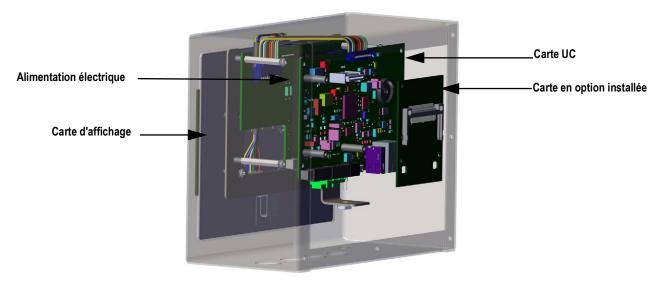
Figure 2-15. Emplacements des cartes dans le boîtier universel
