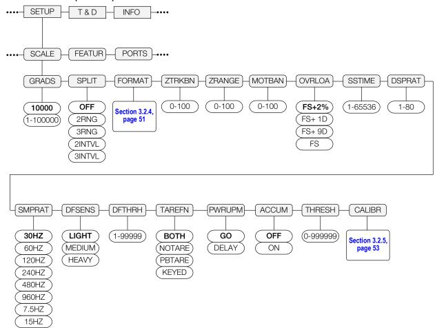
Figure 3-5. Structure du menu Balance
