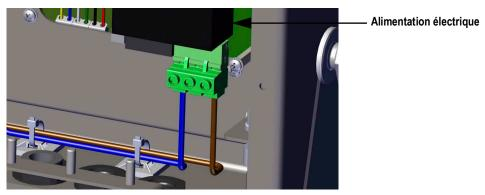
Figure 2-20. Branchement du câble d'alimentation en courant alternatif
