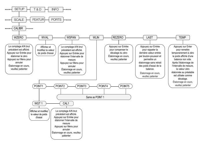
Figure 4-1. Menu d'étalonnage (CALIBR)
