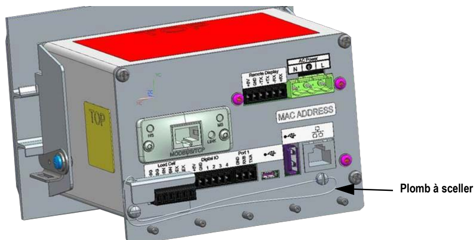
Figure 2-29. Installation du plomb à sceller
