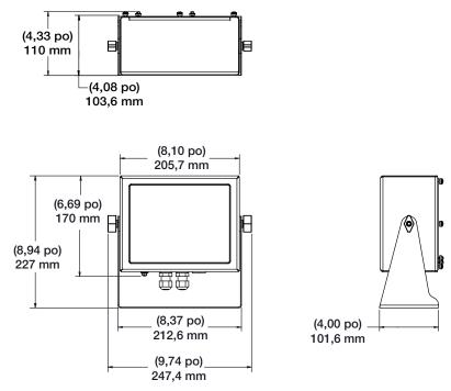
Figure 2-13. Dimensions du boîtier universel
