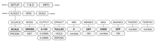
Figure 3-23. Menu de sortie analogique
