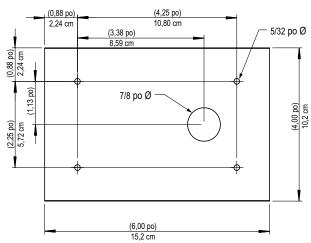
Figure 2-2. Schéma de perçage des trous
