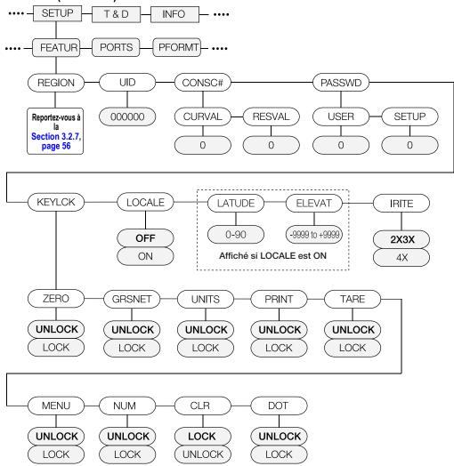
Figure 3-9. Structure du menu de fonctions
