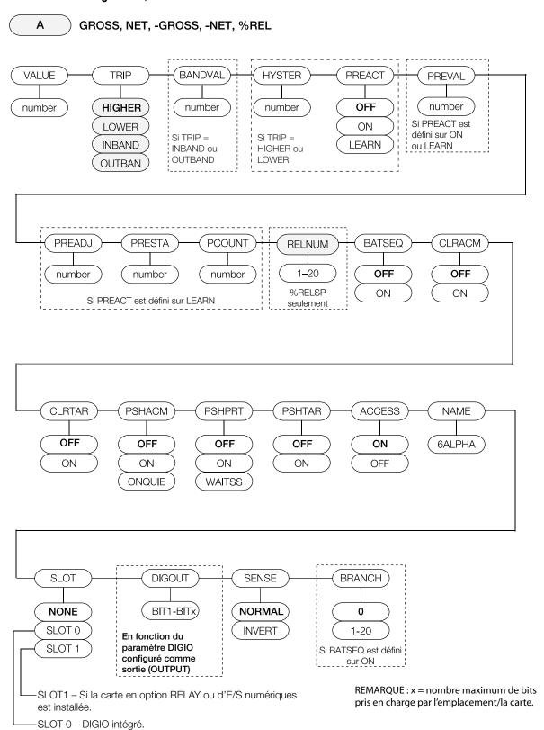
Figure 3-18. Structure du menu de points de consigne – Structure A
