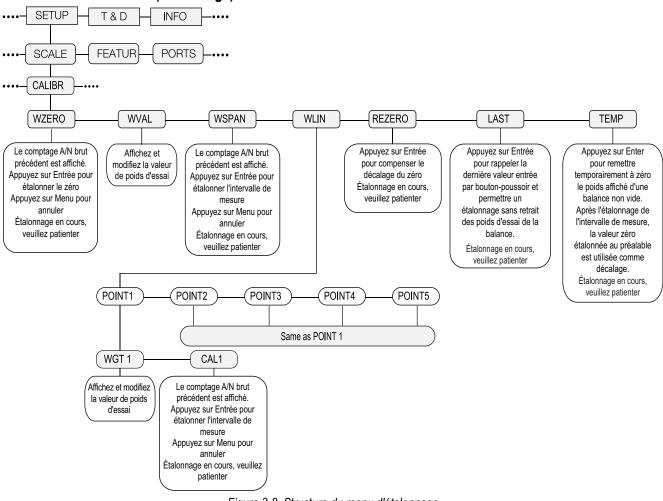
Figure 3-8. Structure du menu d'étalonnage
