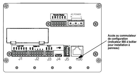
Figure 3-1. Vue arrière – Accès au commutateur de configuration
