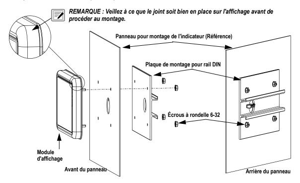
Figure 2-3. Montage du module d'affichage
