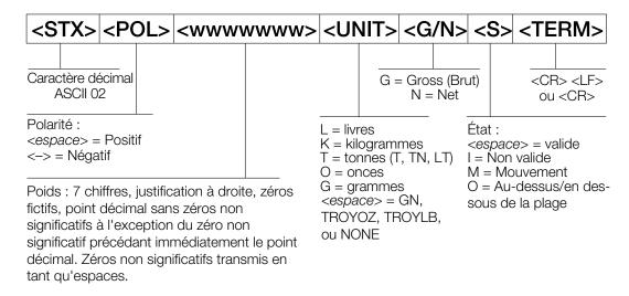
Figure 10-1. Format de flux de données série – RS-232 et RS-422
