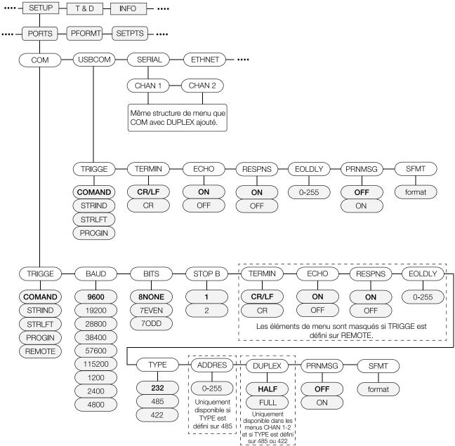
Figure 3-12. Structure des menus COM, USBCOM et SERIAL
