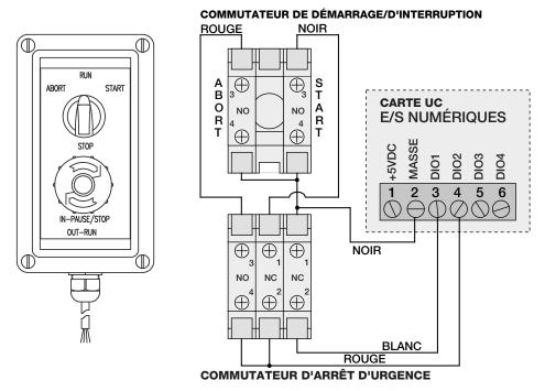
Figure 8-1. Exemple de schéma de câblage et de commutateur de mise en lots
