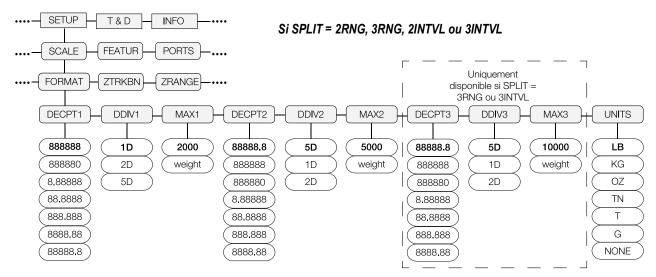
Figure 3-7. Structure du menu Format avec Split 2RNG, 3RNG 2INTVL ou 3INTVL
