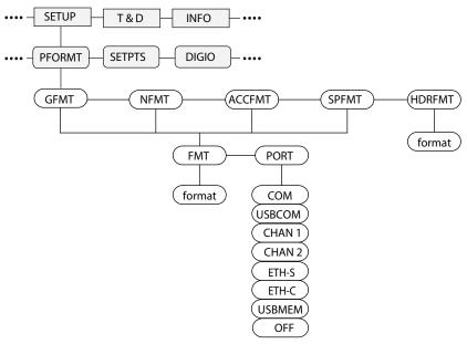
Figure 3-16. Structure du menu de format d'impression
