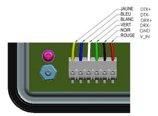
Figure 2-8. Détail des fils du faisceau de câbles
