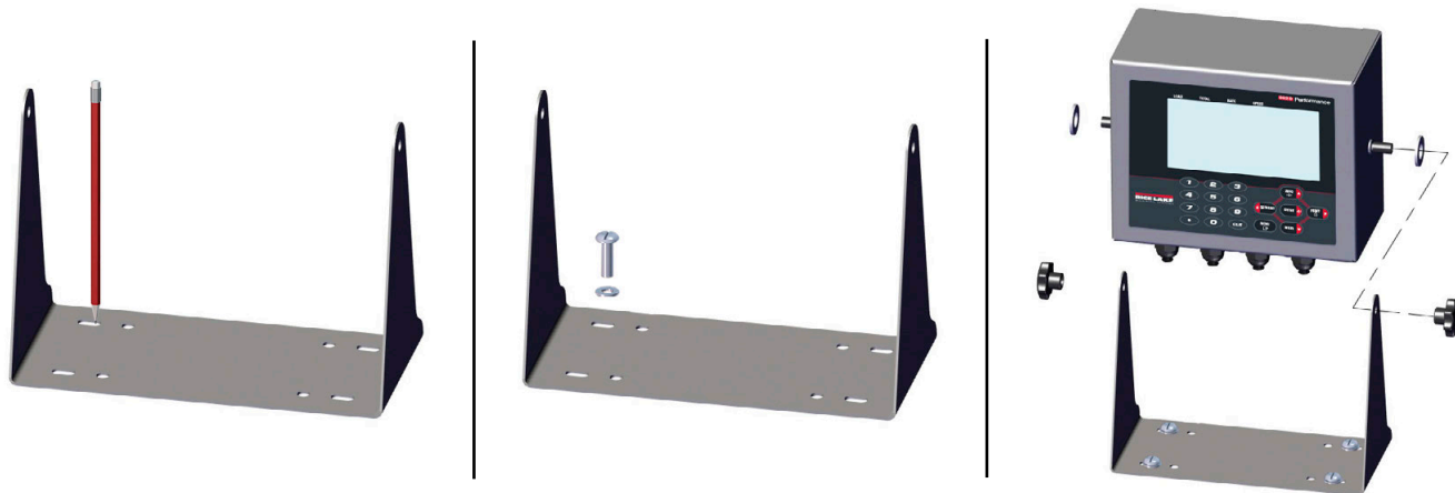
Figure 2-2. Montage de l'unité 882D
