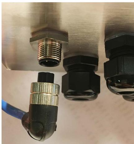
Figure 3. Raccordement des câbles à l'indicateur 882IS
