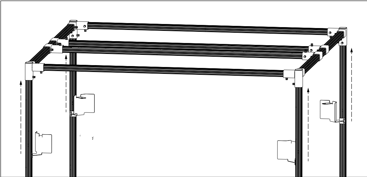
Figure 3-14. Fixation des capteurs IFM distants
