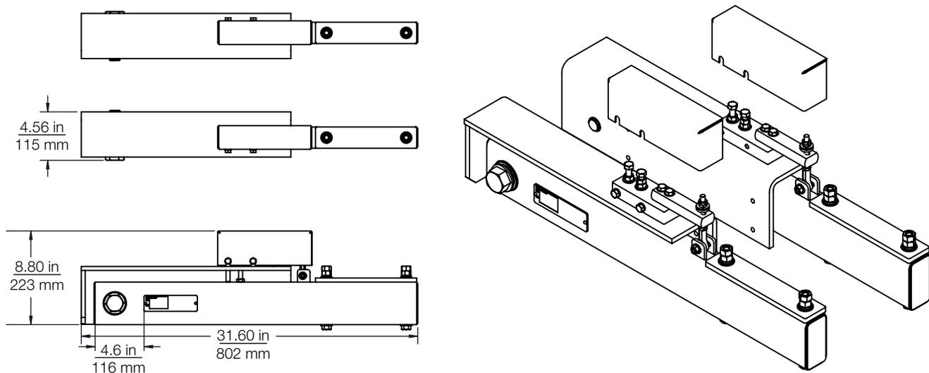
Figure 3-1. Vue du 221DB - Dimensions et assemblage
