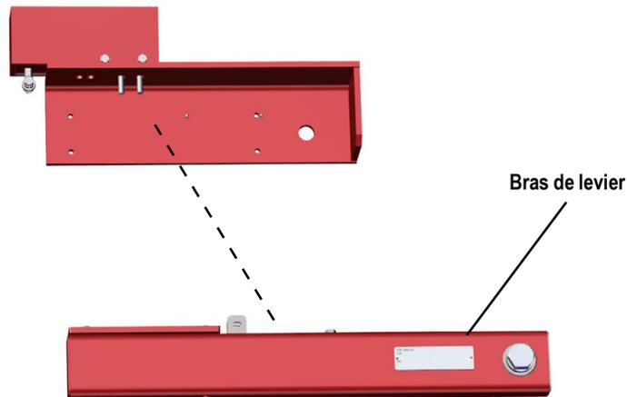
Figure 2-4. Déposez le bras de levier
