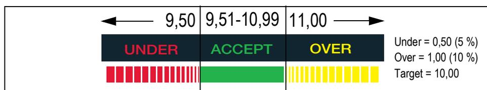
Illustration 5-4. Exemple de réglages Under/Over/Target en mode de pourcentage cible (Target Percent)
