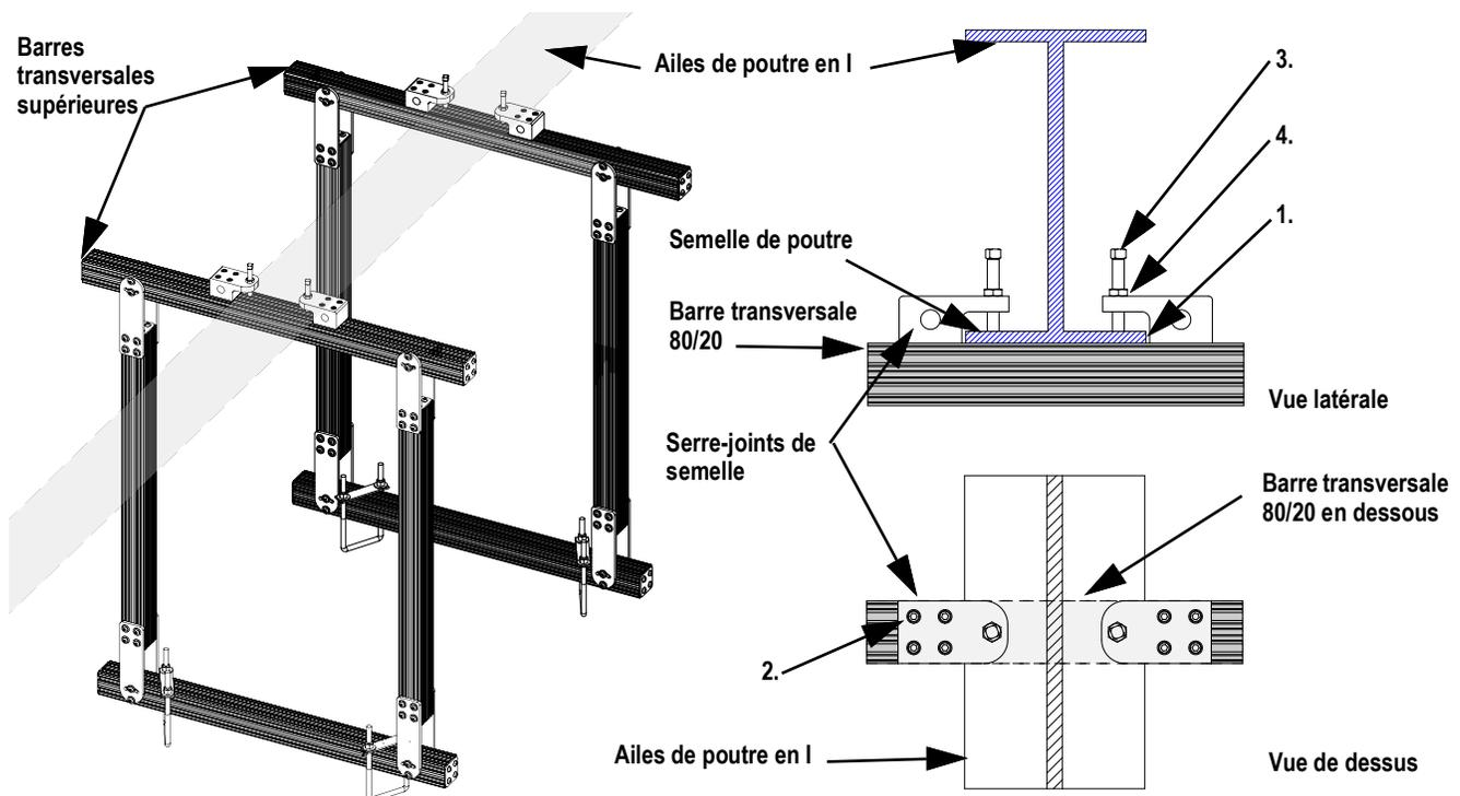
Illustration 10. Serre-joint de semelle de poutre en I
