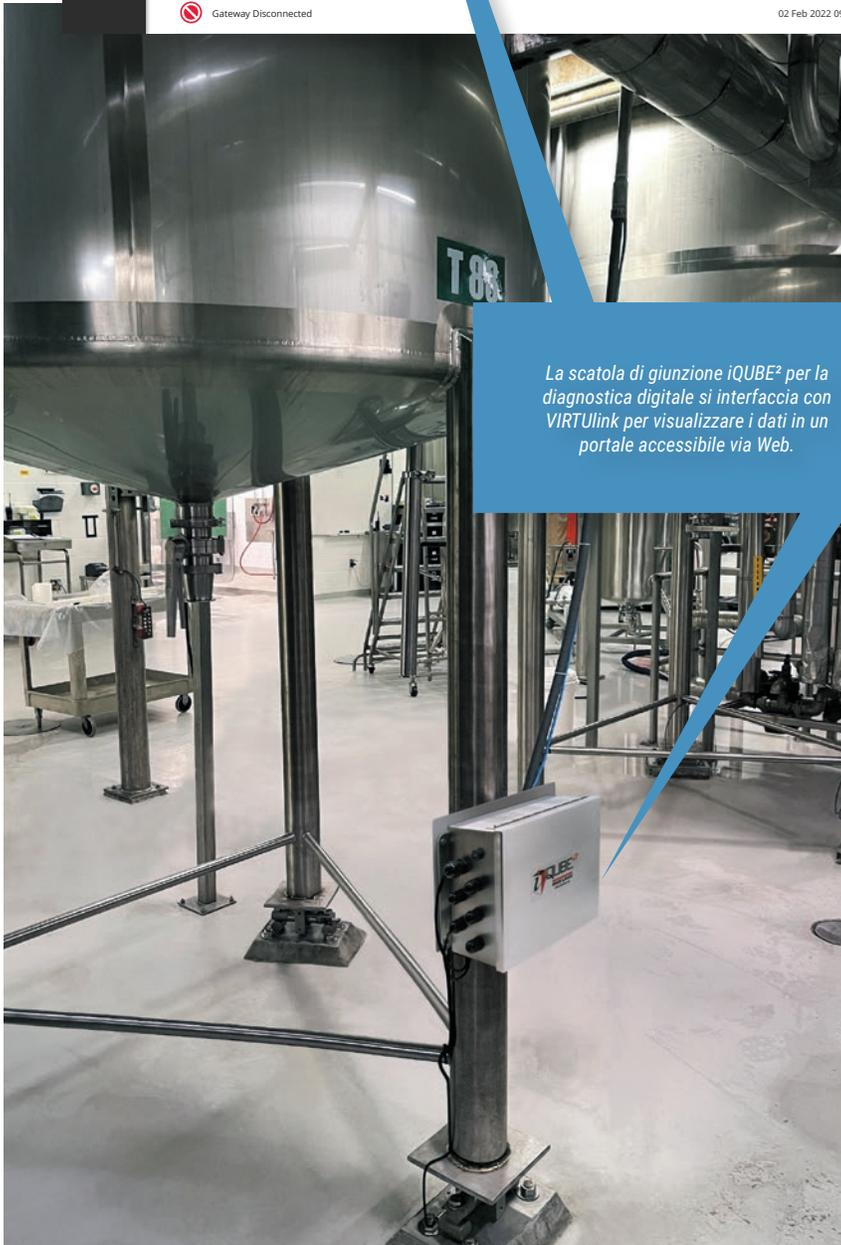
La scatola di giunzione iQUBE<sup>2</sup> per la diagnostica digitale si interfaccia con VIRTUlink per visualizzare i dati in un portale accessibile via Web.
