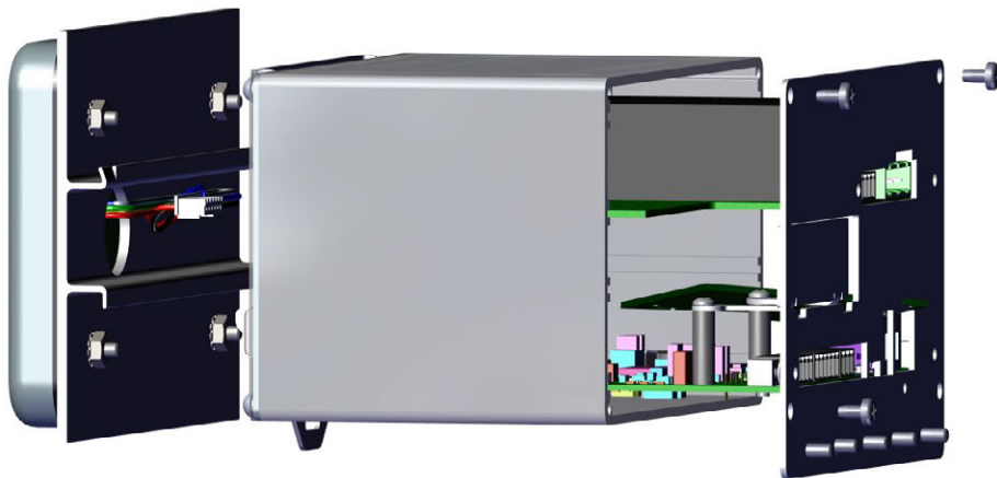
Figura 2-9. Rimozione della piastra posteriore del gruppo controller
