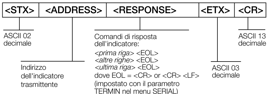
Figura 10-3. Formati dei dati di risposta RS-485
