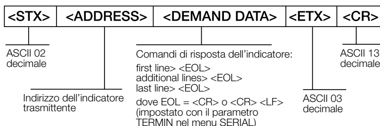
Figura 13-4. Formati dei dati di risposta RS-485
