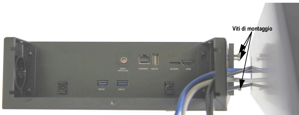
Figura 3-13. Passaggio dei cavi attraverso la testa
