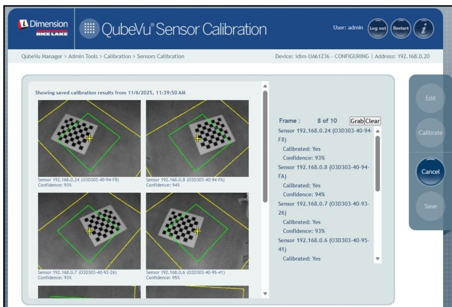
Figura 6-22. Oggetto di calibrazione sotto il sistema di dimensionamento
