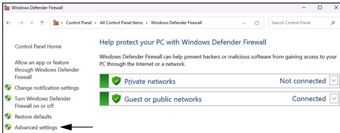
Figura 2-7. Windows Defender Firewall con indicazione delle impostazioni avanzate (Advanced Settings)
