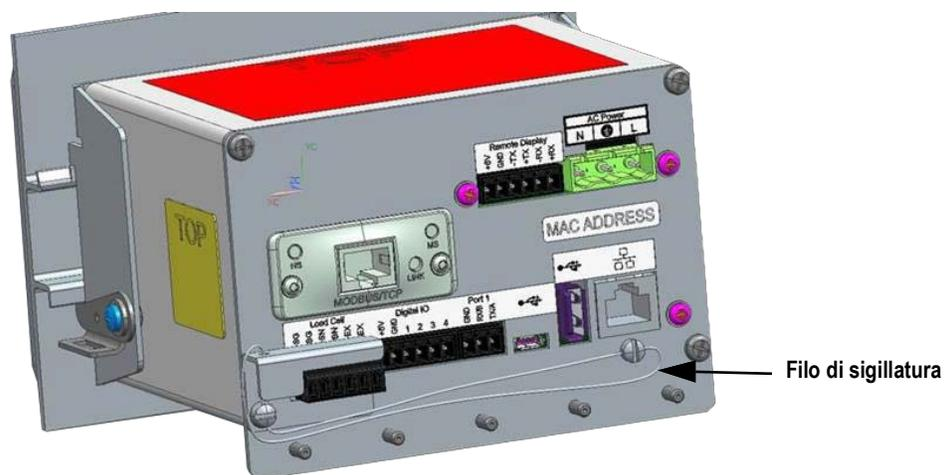
Figura 2-29. Installazione del filo di sigillatura
