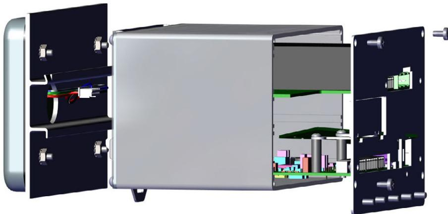
Figura 2-9. Rimozione della piastra posteriore del gruppo controller
