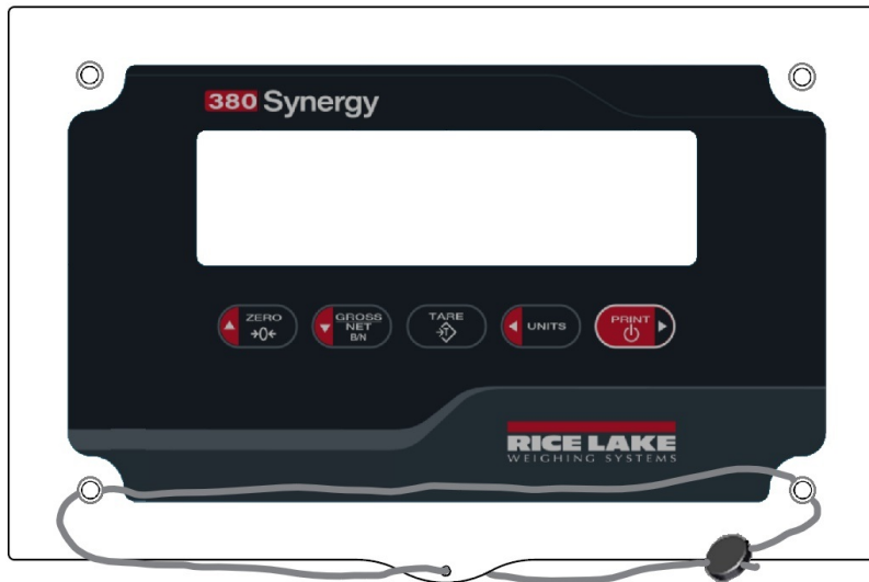
Figura 4-1. Precintado del indicador, prevención del acceso
